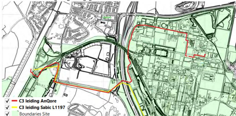
Figuur 1 : Leidingloop C3 Propeenleidingen AnQore en Sabc
